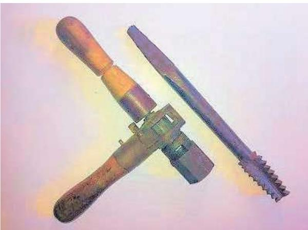
**Gewindebohrer** mit Windeisenrättsche zum Gewindeschneiden in Holz. Holzgewinde waren im 19. Jahrhundert sehr beliebt, da Holz in grossen Mengen zur Verfügung stand, während Metallteile teuer eingekauft werden mussten.
