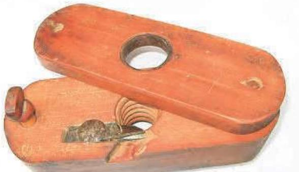
Mit dieser **Filiere** wurden Gewindestangen aus runden Holzstäben geschnitten. Durch das eingebaute Messer wurde das Holz so abgetragen, dass ein Gewinde entstand. Harthölzer wurden für Spindeln verschiedener Werkzeuge verwendet.
