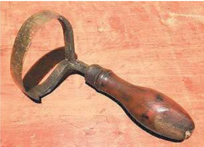
Mit diesem **Zugeisen** wurden die Überzähne auf der Innenseite des fertigen Fasses entfernt. Die Übergänge von Daube zu Daube sollten möglichst klein sein, damit sich in den Überzähnen keine Safffeststoffe und Hefereste festsetzen können.
