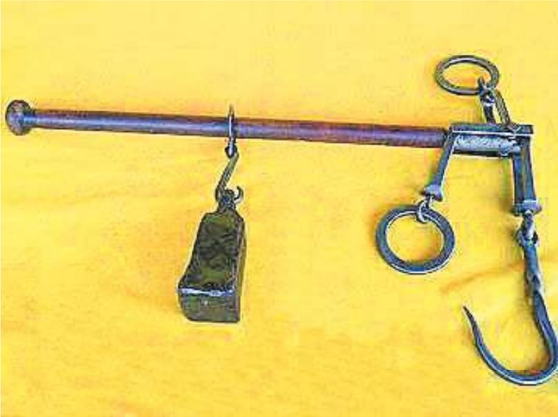
Die Balkenwaage wurde hauptsächlich auf dem Markt verwendet. Die Waage wurde am Ring aufgehängt und das Wägegut an den Haken gehängt. Eine Masseinteilung auf der Holzstange zeigte das ermittelte Gewicht an. Die Waage konnte gedreht und am zweiten Ring aufgehängt werden. Dadurch verändert sich der Hebelarm um das Fünffache. Es konnten also fünfmal schwerere Gegenstände gewogen werden.
