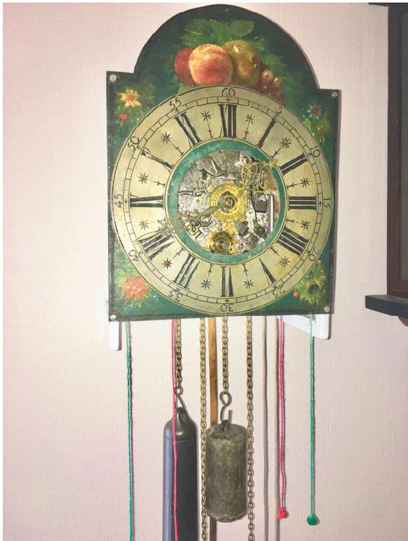
So sieht die Uhr heute aus. Die beiden grünen Schnüre mit den Würfeln ganz aussen sind zum Ein- und Ausschalten des Schlagwerks. Die roten Schnüre mit den Kugeln sind für das Nachschlagen des Schlagwerks. Die unterschiedlichen Formen der Schnurenden wurden so gewählt, dass auch im Dunkeln die richtigen Schnüre bewegt werden können. Die beiden kleinen Gewichte rechts sind für das Schlagwerk zuständig. Das grosse Gewicht links ist für das Schlagwerk und das etwas kleinere Gewicht für das Laufwerk.
