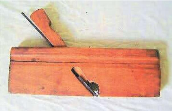
**Der Simshobel** ist in der Regel sehr schmal und das Messer ist so breit wie der Hobel. Dieser Hobel wird für die Nachbearbeitung eines Falzes verwendet.
