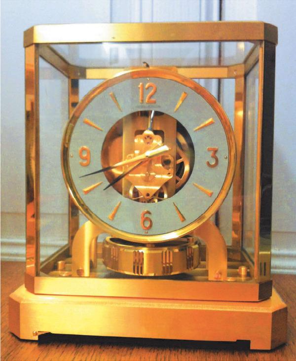
Die ATMOS (Atmosphärische Uhr) ist eine Tischuhr der Uhrenmanufaktur Jaeger-Le Coultre. Sie bezieht ihre Antriebsenergie aus der Ausdehnung und Kontraktion eines mit dem Gas Chlorethan gefüllten Druckbehälters durch Änderung der Umgebungstemperatur oder des Luftdrucks. Die Energie wird in einer Feder gespeichert. Nach Angaben des Herstellers reicht ein Temperaturunterschied von 1 °C aus, um die Uhr etwa 2 Tage lang aufzuziehen.
