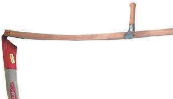
Die Sense, das Werkzeug schlechthin zum Mähen von Gras. Im 19. Jahrhundert wurde das Gras noch von Hand gemäht, denn erst nach 1850 hielten Mähmaschinen bei den wohlhabenden Bauern Einzug. Damals wie heute ist es wichtig, dass die Sense oder „Sägis“ so scharf schneidet, dass die Halme abgeschnitten und nicht gekappt werden. Es war auch der Stolz des Bauern, wenn keine Grasreste auf der Wiese zurückblieben und die
