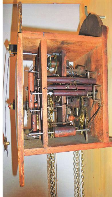
Ankerengang, hölzerne Achsen, teilweise hölzerne Zahnräder und Reibrad zum Schwingflügel. 2 seitlich angebrachte Tonfedern für  $\frac{1}{4}$ ,  $\frac{1}{2}$ ,  $\frac{3}{4}$  und Stundenschlag. Bei jedem  $\frac{1}{4}$  Schlag werden beide Federn im Doppelschlag angeschlagen und die aktuelle Stunde auf der grösseren Feder wiederholt. Gangdauer ca. 12 Stunden
