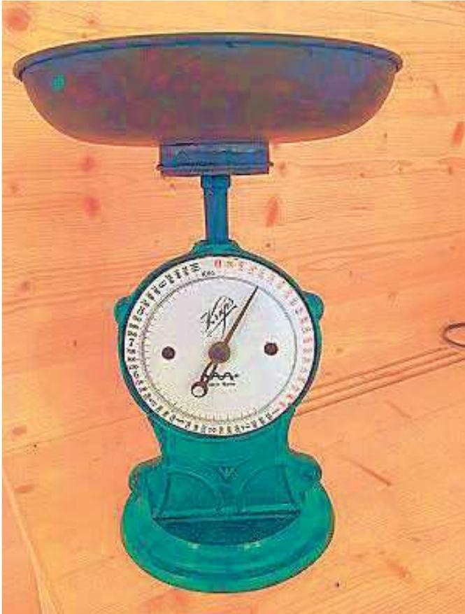
Eine Küchenwaage mit analoger Anzeige durch einen zentralen Zeiger. Die Waage wurde um 1900 von der deutschen Firma Krups hergestellt. Die Waage ist für ein maximales Gewicht von 10 kg geeignet. Die runde Schale ist abnehmbar.
