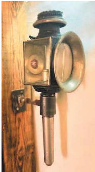
Diese beiden Kutschenlampen gehören zu einem Paar. Die Lampen waren vorne links und rechts an der Kutsche angebracht. Die Lampen waren so montiert, dass nach vorne und auch ein seitlicher Lichtschimmer vorhanden war, nur um gesehen zu werden. Auf dem Bild rechts sieht man, dass auch nach hinten ein kleines rundes rotes Glas, schön sternförmig geschliffen, angebracht war. Die Lampen wurden mit Kerzen betrieben. Im unteren Stiel ist eine Feder eingebaut, welche die Kerze immer nach oben drückt.
