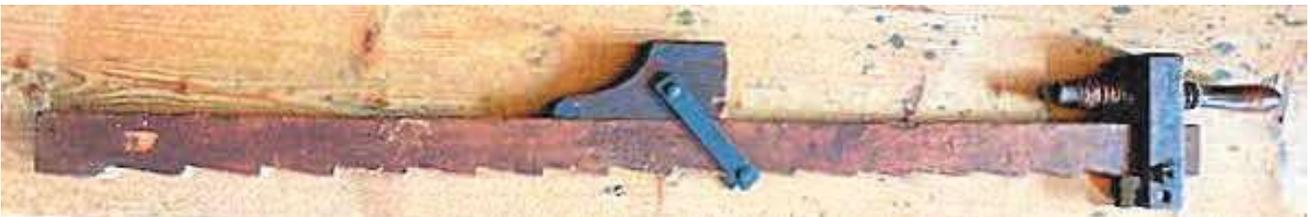
Schraubzwinde aus Holz gefertigt. Länge 1.25m und wie im 19.Jh. üblich, mit Holzgewinde.
