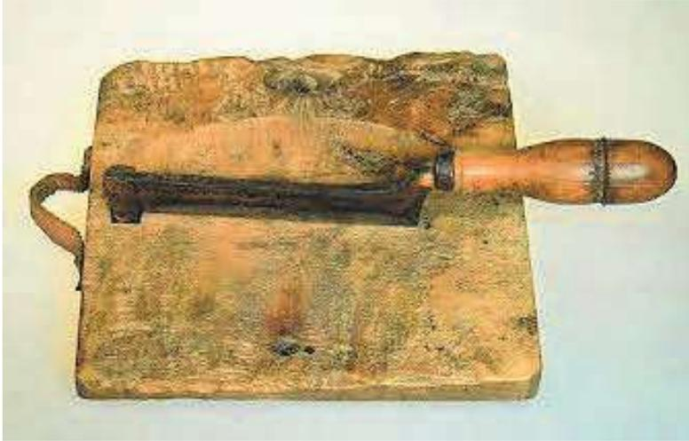
Dieses einfache Gerät hing im 19. und 20. Jahrhundert in fast jeder Küche an der Wand. Nach dem Essen schnitt der Vater ein Stück Tabak ab und stopfte damit seine Pfeife.
