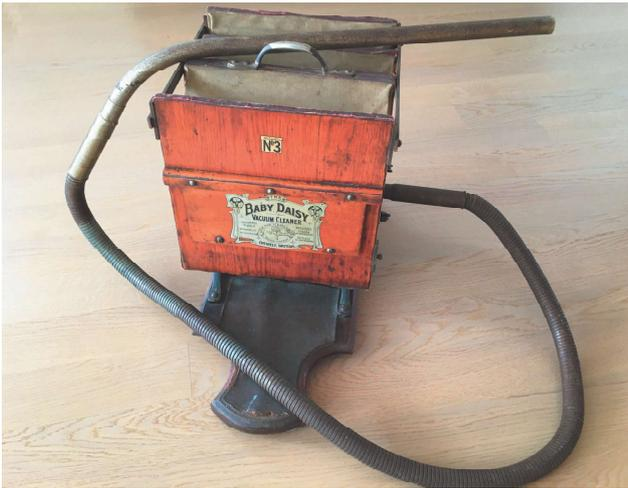
Dieser handbetriebene Staubsauger hat zwei Blasebälge, die ein Vakuum erzeugen. Das Gerät wurde vor allem in Haushalten mit Dienstpersonal eingesetzt. Nicht wie auf dem Prospekt musste eine Person den Hebel betätigen, während die zweite Person mit dem Schlauch den Schmutz aufsaugte. Das Gerät wurde um 1900 in Frankreich entwickelt und in England gebaut.
