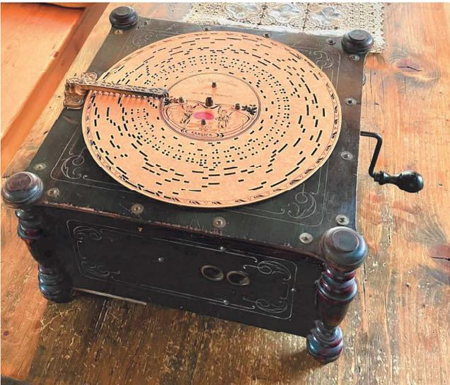
Eine gelochte Pappscheibe ist hier der Träger der Musik. Eine Reihe von Metallstiften tastet die Schlitze der Scheibe ab. Trifft der Stift auf eine Öffnung, gibt er den Luftstrom der entsprechenden Pfeife frei. Angetrieben wird die Organette von einer Handkurbel, die sowohl die Drehung der Scheibe als auch den Blasebalg für die Luft der Pfeifen antreibt.
