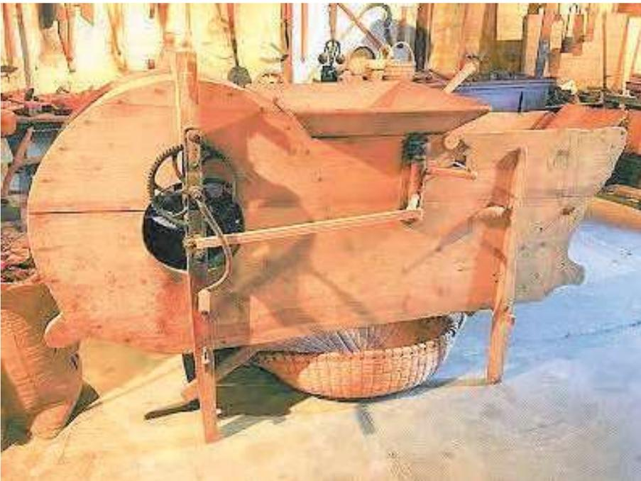
Die Röndel ist eine Windmühle in einem Gehäuse. Im linken runden Teil befindet sich ein Windrad, das mit einer Kurbel angetrieben wird. Im Trichter wird ein Gemisch aus Körnern und Spreu in den Luftstrom gestreut. Die schwereren Körner fielen durch den Luftstrom und wurden unter dem waagerechten Kanal aufgefangen.
