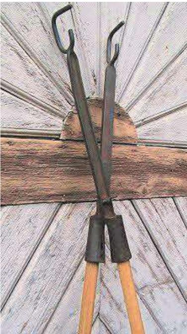
Dieses seltsam anmutende Gerät diente dazu, sehr lange Holzleitern in der Mitte zu stützen. Die beiden Holzstangen auf dem Bild sind zwischen 5 und 6 Meter lang. Mit den beiden Metallspangen wurde eine Sprosse eingefädelt und dann die Holzstangen am Boden verspiesst.
