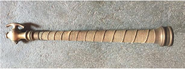
Die ersten Strahlrohre waren noch sehr einfach ausgestattet. Das Strahlrohr hatte nur einen Hahn, um das Wasser auf- und abzudrehen. Um die kalten Hände des Strahlrohrführers zu schützen, war das Strahlrohr mit einer Schnur umwickelt. Von einer Dusch- oder gar Manschutzeinstellung konnte noch keine Rede sein.
