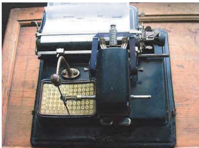
Diese Schreibmaschine wurde 1903 von Friedrich von Hefner-Alteneck entwickelt und von 1904 bis 1934 von der AEG gebaut. Bei dieser Schreibmaschine diente eine Typenwalze (Typenzylinder) als Träger der darstellbaren Zeichen (Typen). Die Typenwalze war auswechselbar. Für das ab 1924 angebotene Modell 4 waren über 36 verschiedene Typenwalzen erhältlich, darunter auch 2 Typenwalzen mit kyrillischen Buchstaben. Zu jeder Typenwalze gehörte eine auswechselbare Tafel
