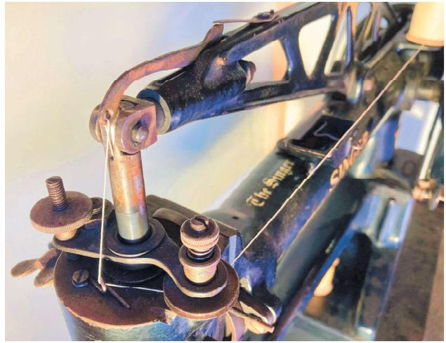
Die Schuhmacher-Nähmaschine wurde im Jahre 1924 hergestellt. Die SINGER 29K hat ein eigenes Patent für die Fadenführung. Diese Maschine kann mittels Verdrehens des Drehflügels in die gewünschte Richtung nähen. Für eine Richtungsänderung muss der Fuss mittels des Presserhebels angehoben werden. Der lange Ausleger und die Möglichkeit der Nährichtung ermöglicht es Stiefel-Schäfte zu nähen.
