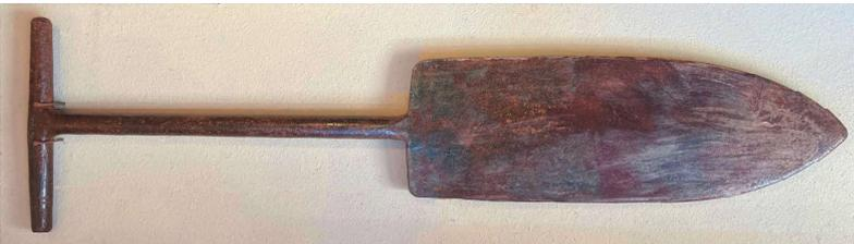
Die Schaufel wurde in den Boden gesteckt und zur Seite gedrückt. Dann wurde der Tannentrieb in den Spalt gelegt. Anschliessend wurde das Setzeisen dicht neben dem Setzling eingeschlagen und der Spalt geschlossen. Die Länge des Setzeisens von 90 cm entsprach auch dem empfohlenen Abstand zwischen den Tannen.
