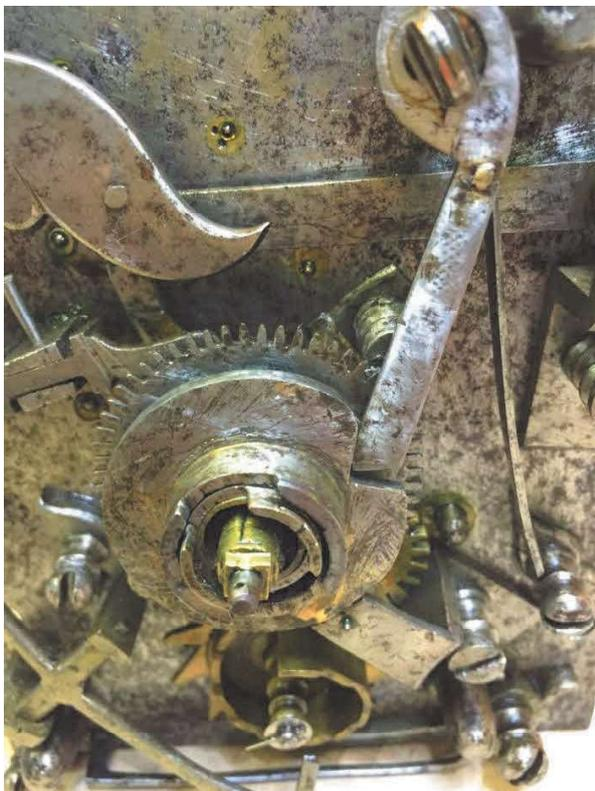
Neue Messingbuchsen für ausgeschlagene Lager sind bei solchen Uhren häufig zu sehen, aber auch ein aufgeschweißter Zahn am „Wecker“-Zahnrad zeugt von sehr guter Handwerkskunst der damaligen Zeit.
