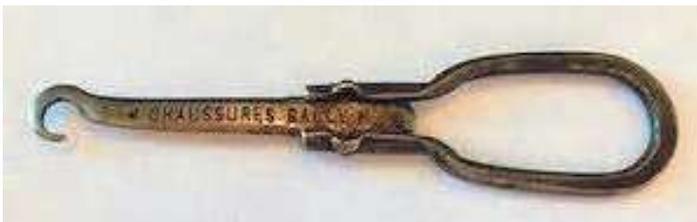
Dieser spezielle Haken wurde verwendet, um die hohen Stiefel der Damen zu binden. Die Schuhbänder waren so lang, dass man sie nicht von Hand nachziehen konnte. Mit diesem Instrument wurde diese Aufgabe spielend gelöst. Zusammengeklappt passte er in jede Damenhandtasche.
