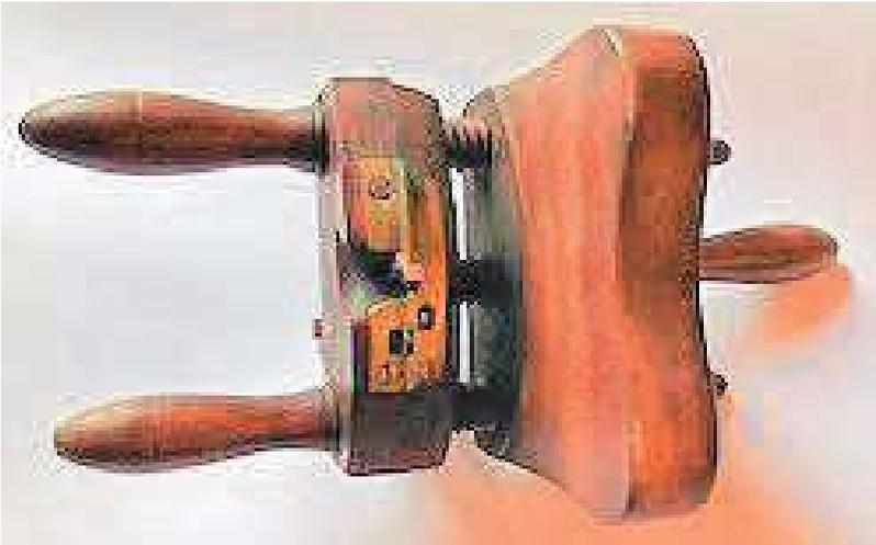
Dieser **Spezialhobel** wurde benötigt, um an einem Fass die Ringnut für die Aufnahme des Bodens bzw. des Deckels zu hobeln. Mit den beiden Holzspindeln konnte der Abstand eingestellt werden. Je breiter die Nut sein sollte, desto mehr Arbeitsgänge waren nötig.
