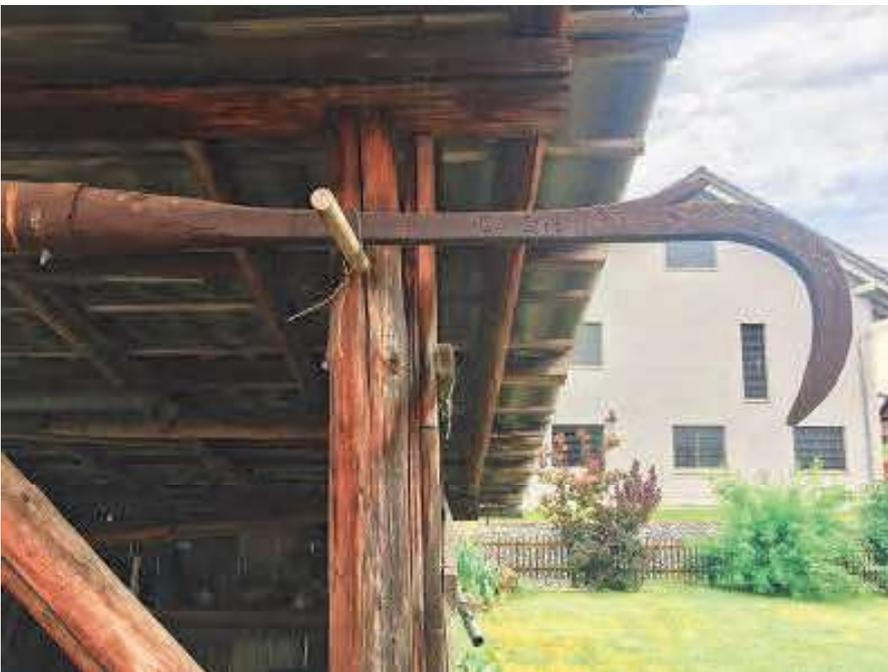
Dieser Mauereinreissshaken stammt von der Feuerwehr Hessenreuti und ist mit «GMDH 1835» datiert. Die Gesamtlänge dieses Gerätes beträgt 7,8 m und hat 2 seitliche Streben. Dieser Haken wurde von mindestens 4 Mann bedient. Nach einem Brand wurden die ausgeglühten und freistehenden Mauern eingerissen, um die Gefahr eines unkontrollierten Einsturzes zu bannen.
