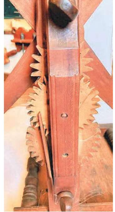
Nachdem die Fäden auf dem Spinnrad hergestellt worden waren, mussten sie zu Strängen aufgewickelt werden. Schon damals gab es eine gewisse Normierung. Das Wickelrad, hier ein Exemplar aus dem Jahr 1826, ist mit einem Zählwerk ausgestattet. Auf dem mittleren Rad (siehe Bild rechts) ist ein Stift angebracht. Ein dünner Holzspan, der am Rahmen befestigt ist, liegt auf dem Stift auf. Wenn das Zählwerk hundert Umdrehungen erreicht hat, löst
