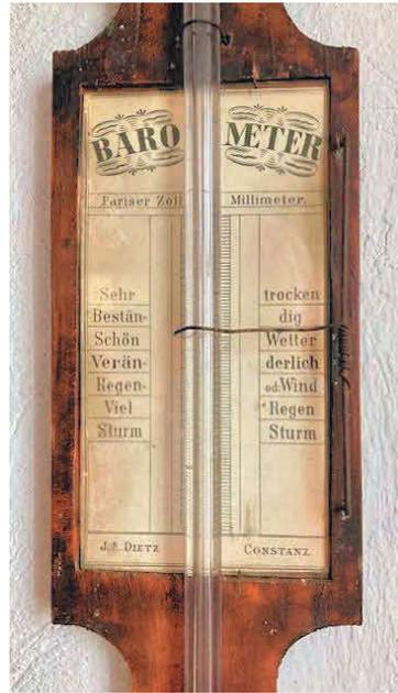
Ein **Quecksilberbarometer** besteht aus einem mit Quecksilber gefüllten senkrechten Rohr, das am oberen Ende luftdicht verschlossen ist. Das untere Ende taucht in ein Vorratsgefäß, das ebenfalls Quecksilber enthält.
