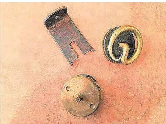
Dieses raffinierte Flickzeug wurde mit dem spitzen Ende in den unter Druck stehenden Schlauch geschraubt. Mit dem kleinen Schlüssel wurde die Überwurfmutter mit der darunter liegenden Gummidichtung auf den Schlauch geschraubt. So konnte ein Schlauchdefekt behoben werden, ohne den Löscheinsatz zu unterbrechen. Bei den älteren Schläuchen waren Beschädigungen keine Seltenheit.
