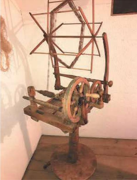
Die von den „alten Knackern“ erzeugten Fäden wurden auf dem Spulrad auf die Spulen gewickelt, die in die Schiffchen der Webstühle eingelegt wurden. Erst jetzt, nach vielen Arbeitsschritten, konnte an das Verweben der Fäden zu Stoffen gedacht werden.
