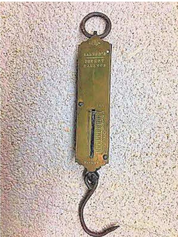
Diese Milchwaage hing früher in jedem Kuhstall. In der Mitte des Stallganges. Sie hing an einem Deckenbalken und war von allen Seiten schnell erreichbar. Nach dem Melken, natürlich von Hand, wurde die Milchmenge jeder Kuh gewogen. Damit hatte der Bauer eine Kontrolle über die Leistung und eventuell auch über den Gesundheitszustand seiner Tiere.
