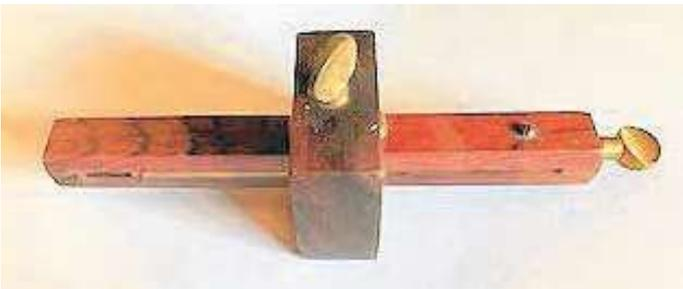
Der **Parallelreisser** ist eine Mischung aus Messschieber und Parallelreisser und wird gerne zum parallelen Anreissen verwendet.
