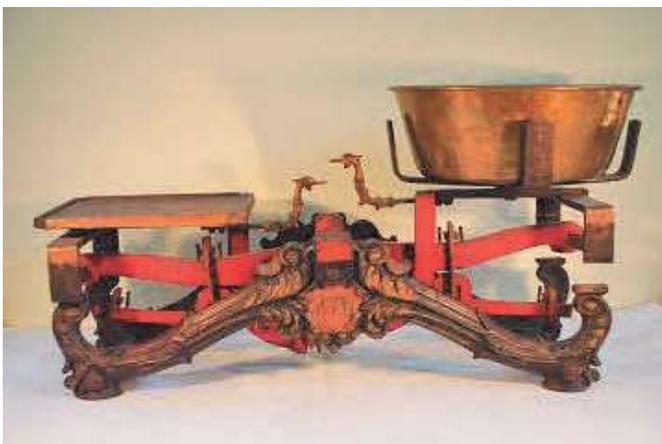
Balkenwaage oder Zungenwaage
