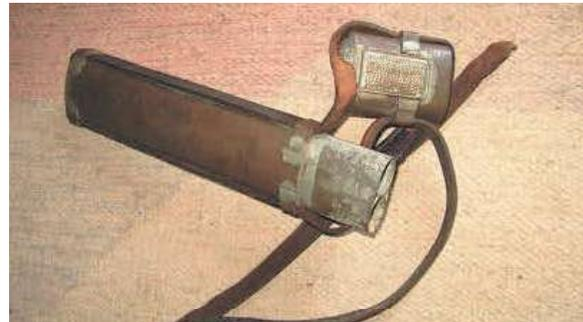
Behälter für 2 Feueralarmraketen. Auf dem Deckel befindet sich eine angelötete Reibfläche. Damit konnten Streichhölzer zur Zündung der Raketen angezündet werden.
