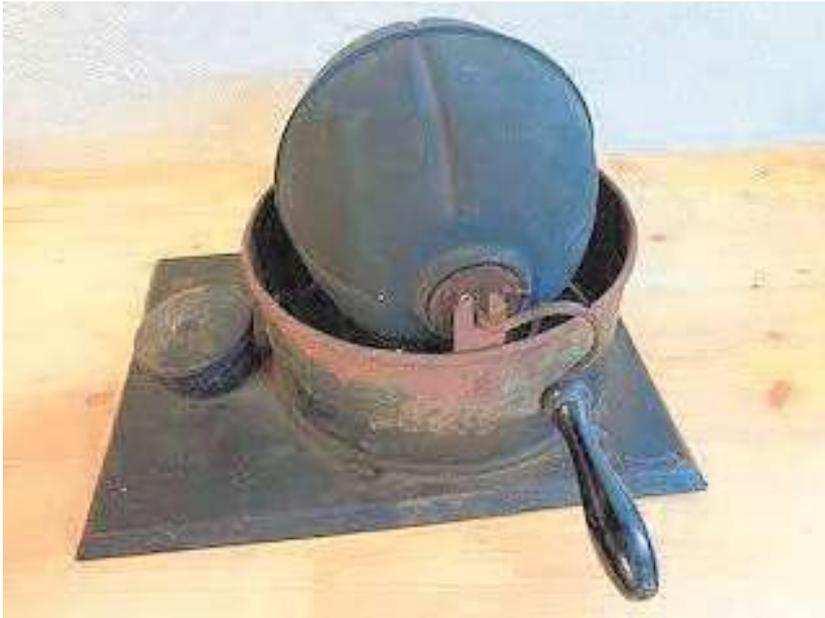
Diese kleine Kaffeerösterei aus dem Jahr 1878 war für den privaten Gebrauch bestimmt. Unter der Kugel mit den Kaffeebohnen befindet sich ein rundes Gefäß, in dem der Spiritus brennt. Zum Nachfüllen konnte (im Bild links) der kleine Deckel abgehoben und Spiritus eingefüllt werden. Durch gleichmässiges Drehen der Kurbel wurden die Kaffeebohnen nach Belieben geröstet.
