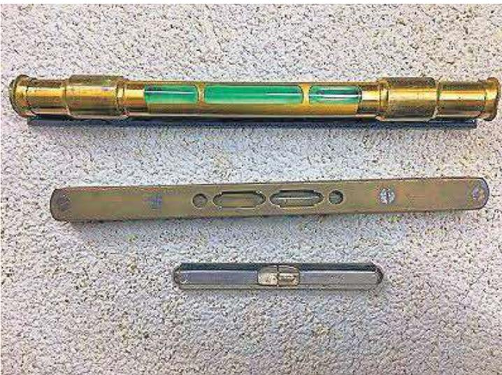
Eine Wasserwaage dient nicht zum Wiegen, sondern zum Ausrichten. Diese 3 Exemplare sind jedoch für ihren eigentlichen Zweck nicht mehr verwendbar, da sie zu ungenau wurden.
