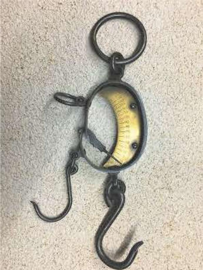
Sackwaage zum Wiegen von Obst oder Getreide. Die Waage wurde am oberen Ring aufgehängt. Am unteren Haken wurden die Säcke aufgehängt. Auf der Messingskala konnte das Gewicht abgelesen werden. Die grosse Skala reichte bis 150 kg.
