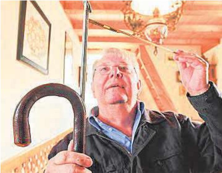
Stock eines Pferdehändlers. Eingebaut ist eine Messlatte mit Ausleger und Wasserwaage zur Messung des Stockmasses eines Pferdes.
