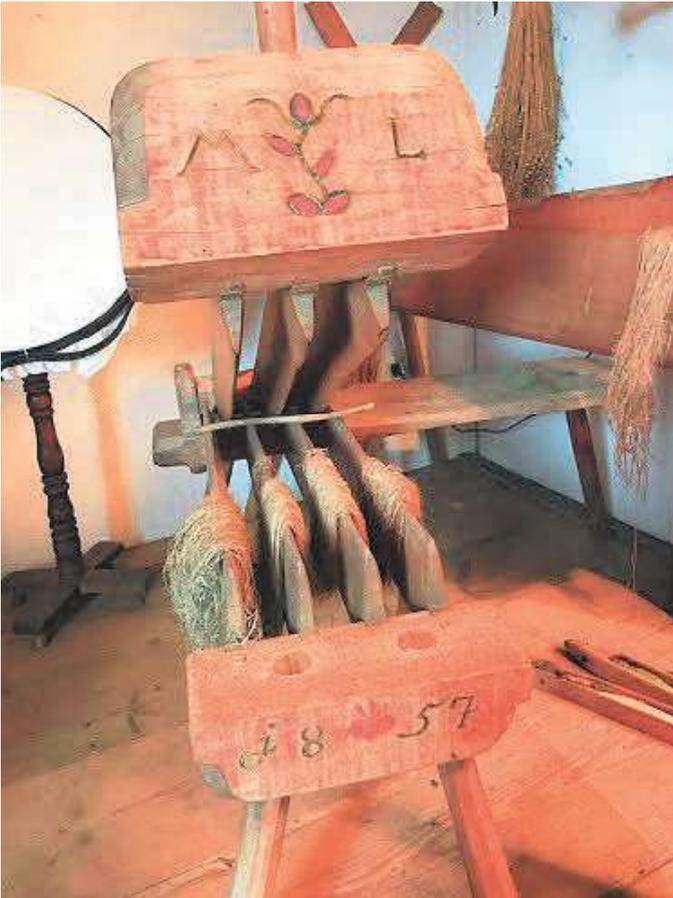
Mit der Flachsbreche wurden die Stängel gebrochen und geknickt, um sie für die Weiterverarbeitung zu textilen Produkten zu nutzen.
