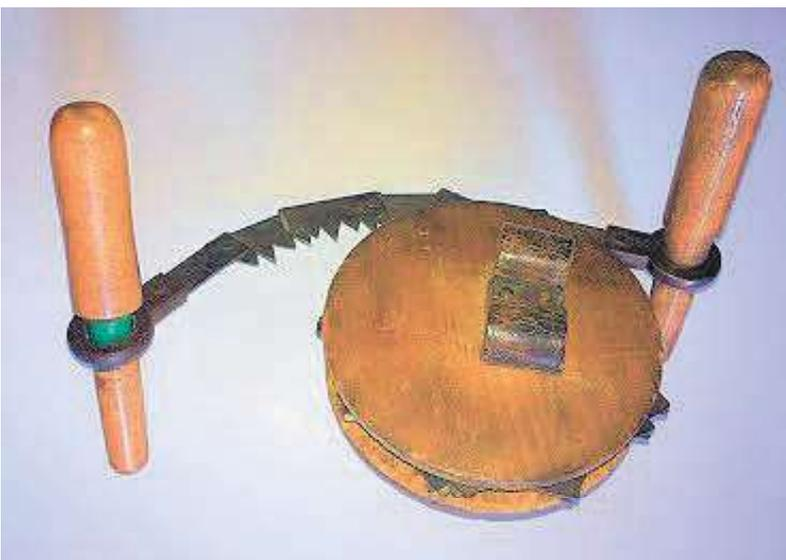
Kettensäge der Schweizer Armee aus dem Jahr 1900. Die Säge ist aufgerollt und besteht aus 34 Sägeblättern mit einer Länge von je 35 mm. Die ausgebreitete Säge hat somit eine Länge von 1,2 m. Eine einzelne Person kann damit einen Baum fällen, indem sie die Säge um den Stamm legt und an den beiden Holzgriffen in entgegengesetzter Richtung zieht.
